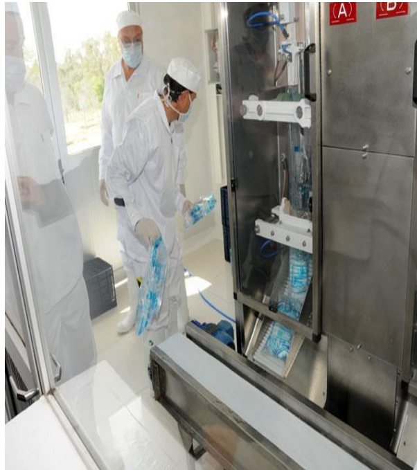
Fig. 41: OSE - Envasado de sachetes de agua potable en Cuchilla Pereyra en Montevideo-UY. Fuente: OSE, 2011a.
